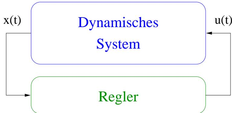
Abbildung 3.6: Prinzip der Regelung: Aus dem Zustand  $x(t)$  des dynamischen Systems ermittelt der Regler die Stellgröße  $u(t)$
